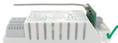
Die easyCONTROL Platinen werden durch einfaches Einsticken in die Einzelbatterieelektronik montiert.
