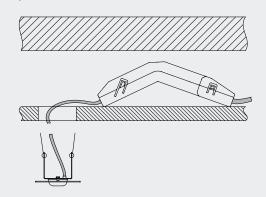
7. Leuchte in Einbauöffnung setzen
