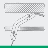
5. Leuchte an Verbindungskabel klemmen 6. Spannfedern nach oben richten und halten
